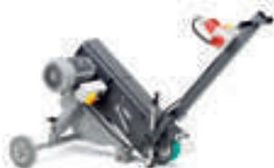
Mobile Fahreinheit für effektive Schleifarbeiten „vor Ort“ am Boden.
